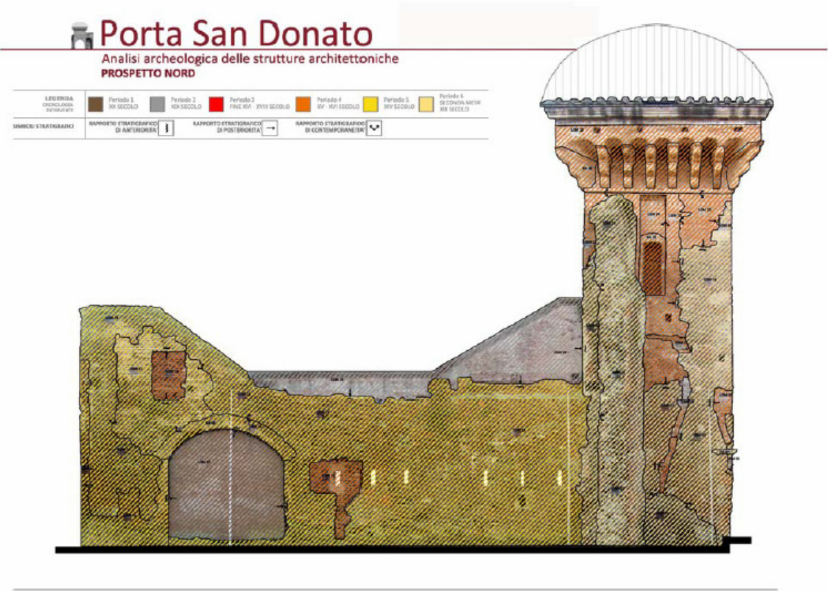
FIG. 2 – Porta San Donato. Analisi stratigrafica delle murature:rilievo con l’individuazione delle porzioni di muratura appartenenti alle sei fasi costruttive emerse dalle analisi.
